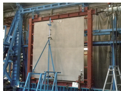
写真4: 静的、動的追従性試験でモルタルの落下はなかった
