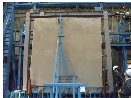
写真3: 既存外壁を想定した試験体は静的追従性試験でモルタルが落下した
