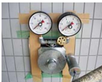
アタッチメントに引張試験器を装着して引張試験を行う。
