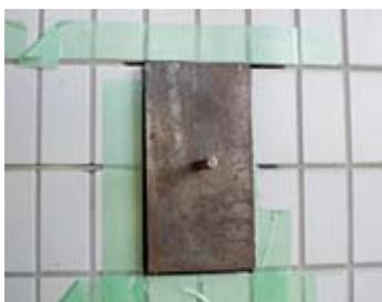
アタッチメントをタイル表面にエポキシ樹脂で接着させ、アタッチメント周囲に切り込みを入れて周辺タイルと縁切る。
