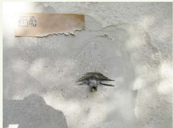
引抜試験を実施するため、ガードピン頭部周りのモルタル撤去及び治具の取付
